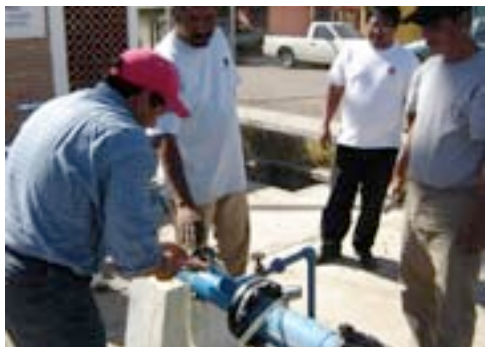
FIGURE 10 : Mesures de pression avec un manomètre de type Bourdon
