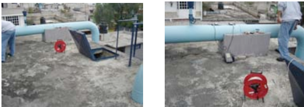
FIGURE 15 : Mesure du niveau dynamique d'un réservoir d'eau de niveau de base
